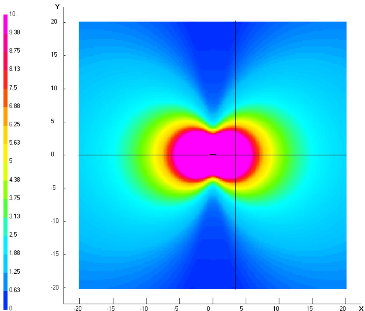
Grenzwert 32 V/m bei etwa 3,2 m, 0,1 A/m bei 4,5 m
