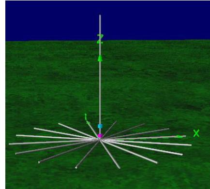
Füge eine Verlängerungsspule in die Antenne ein und berechne deren Induktivität, um Resonanz auf 1,850 MHz zu erzielen.
