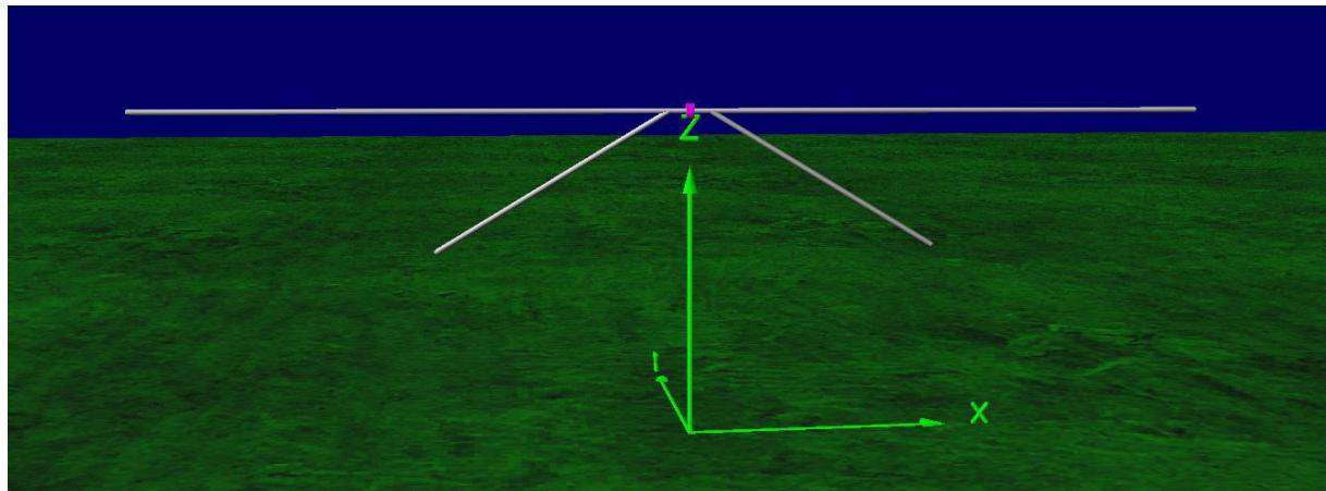
Konstruiere einen Doppeldipol für das 80m- und 40m-Band. Der Dipol für 80m hängt in 12 m Höhe. Der Dipol für 40m soll dabei nach unten abknicken, wie im Bild gezeigt. Dabei habe die Endpunkte des kürzeren Dipols einen Abstand von 5 Metern zum gestreckt hängenden langen Dipol, was man in der Praxis etwa durch vorher abgemessene Leinen realisieren kann. Rechne mit einem durchschnittlichen Boden (Average).
